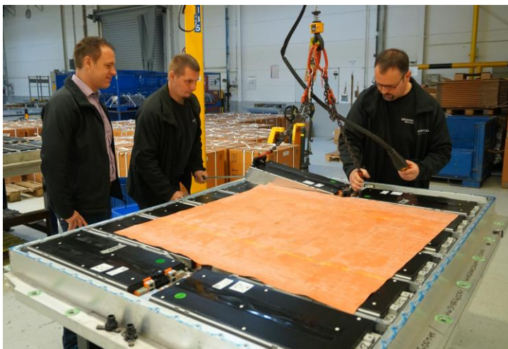
Ausbau der Module der Hochvoltbatterien (v. links): Sebastian Schneider, Christian Henneboh und Markus Schwarz.
