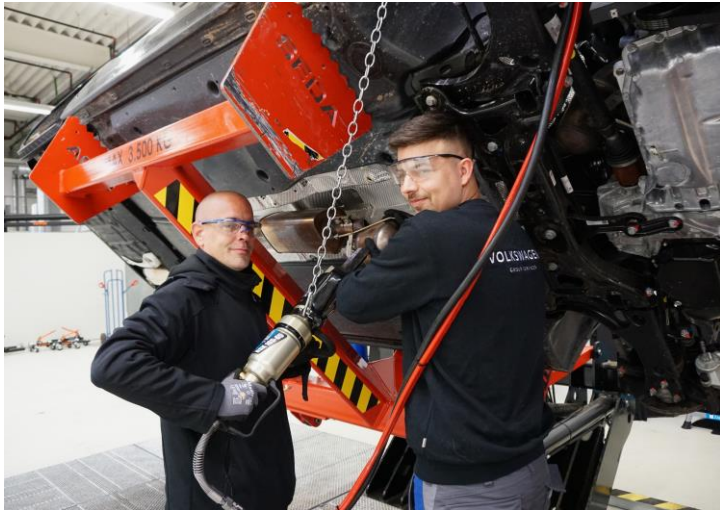
Arbeiten am Kipplifter im Demontagebetrieb: Die Kollegen Robert Nachsel (links) und Fabio Pieper bauen einen Katalysator aus.
